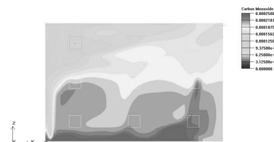
图10 Y=1.7m平面有毒烟气分布云图
